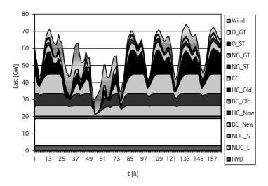
WIND = Windkraftwerke, O ST, O GT = mit Schweröl betriebene Dampf- und Gasturbinen, NG CC = erdgasbefeuerte GuD-Kraftwerke, NG ST, NG GT = mit Erdgas betriebene Dampf- und Gasturbinen, BC New, BC Old = alte und neue Braunkohlekraftwerke, HC New, HC Old = alte und neue Steinkohlekraftwerke, NUC L, NUC S = große und kleine Kernkraftwerke, HYD = Wasserkraftwerke.
