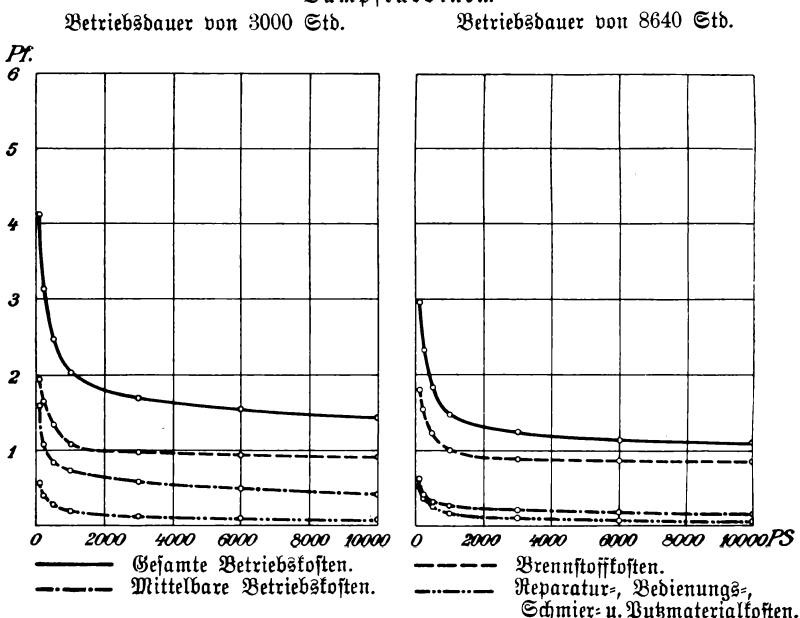
**Gestehungskosten der effektiven Pferdekraftstunde in Abhängigkeit von der Maschinengröße bei verschiedenen Kohlenpreisen.**
