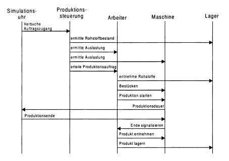
Abbildung 53: Ereignisfolgediagramm für eine Produktionssimulation
