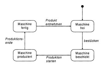
Abbildung 58: Zustandsdiagramm für eine Maschine
