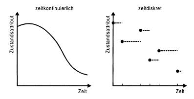
Abbildung 45: Zeitverlauf von Zustandsvariablen bei zeitdiskreten und zeitkontinuierlichen Modellen
