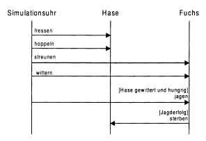
Abbildung 54: Ereignisfolgediagramm für eine Räuber-Beute-Simulation
